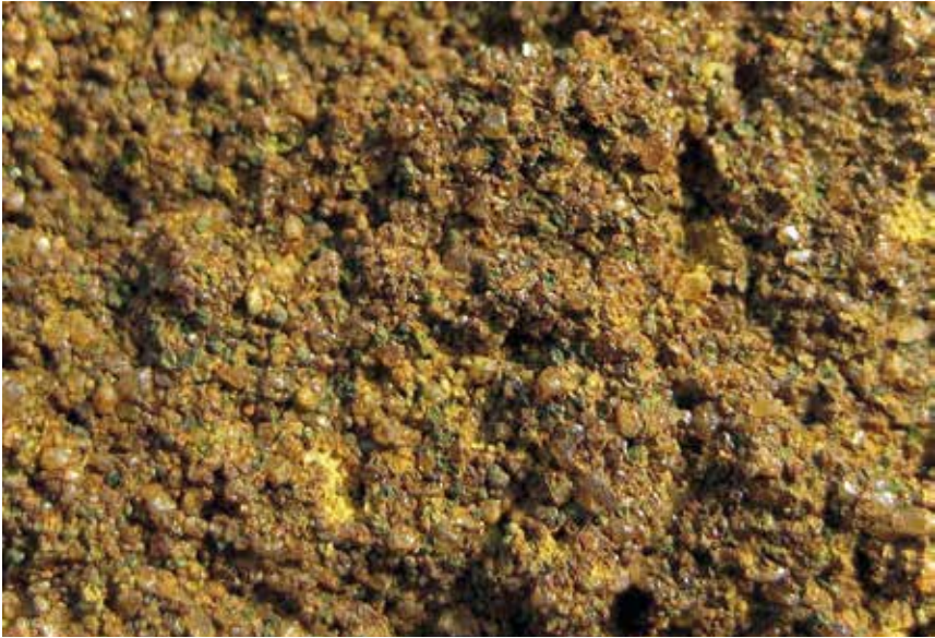
Abb. 33 - Diestischer Sandstein. Das Makrofoto zeigt insbesondere Hämatit und nicht oxidierte Glaukonitkörner, was es ermöglicht, den diestischen eisenhaltigen Sandstein vom brüsseler eisenhaltigen Sandstein zu unterscheiden, in dem der gesamte Glaukonit oxidiert wurde und daher nicht mehr sichtbar ist (Foto R. Dreesen).
